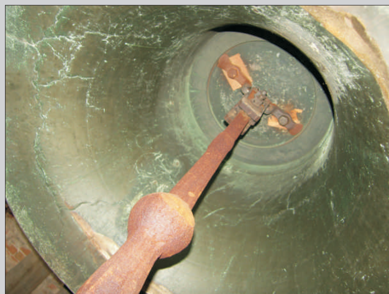
Serce wielkiego dzwonu z Krosna Odrzańskiego i sposób mocowania serca po naprawie urwanego uchwyty wykonanego w trakcie odlewu.
