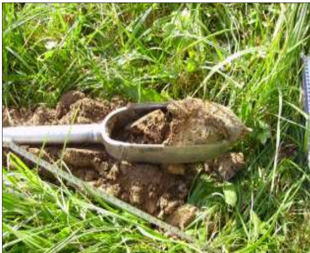
W odwiercie W8, który był wykonywany pod lasem w pobliżu Białej Wody w Szybie, wydobyto piasek z glin.
