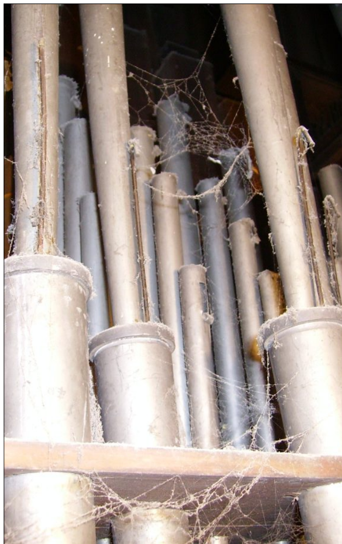
Wnętrze trzech starych organów - rzędy piszczałek wargowych wykonanych ze stopu cyny, bizmutu, czasem cynku i ołowiu i głosów języcznych imitujących cych instrumenty dęte
